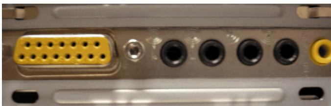
図 11 : 標準的な 5.1 音声の音声ポート設定
